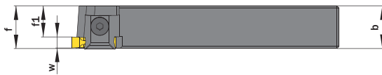
Maße f und w in Abhängigkeit der Schneidplatte Measures f and w depend on cutting insert
